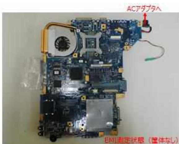
図 2. 3. 31 EMI 測定基板
